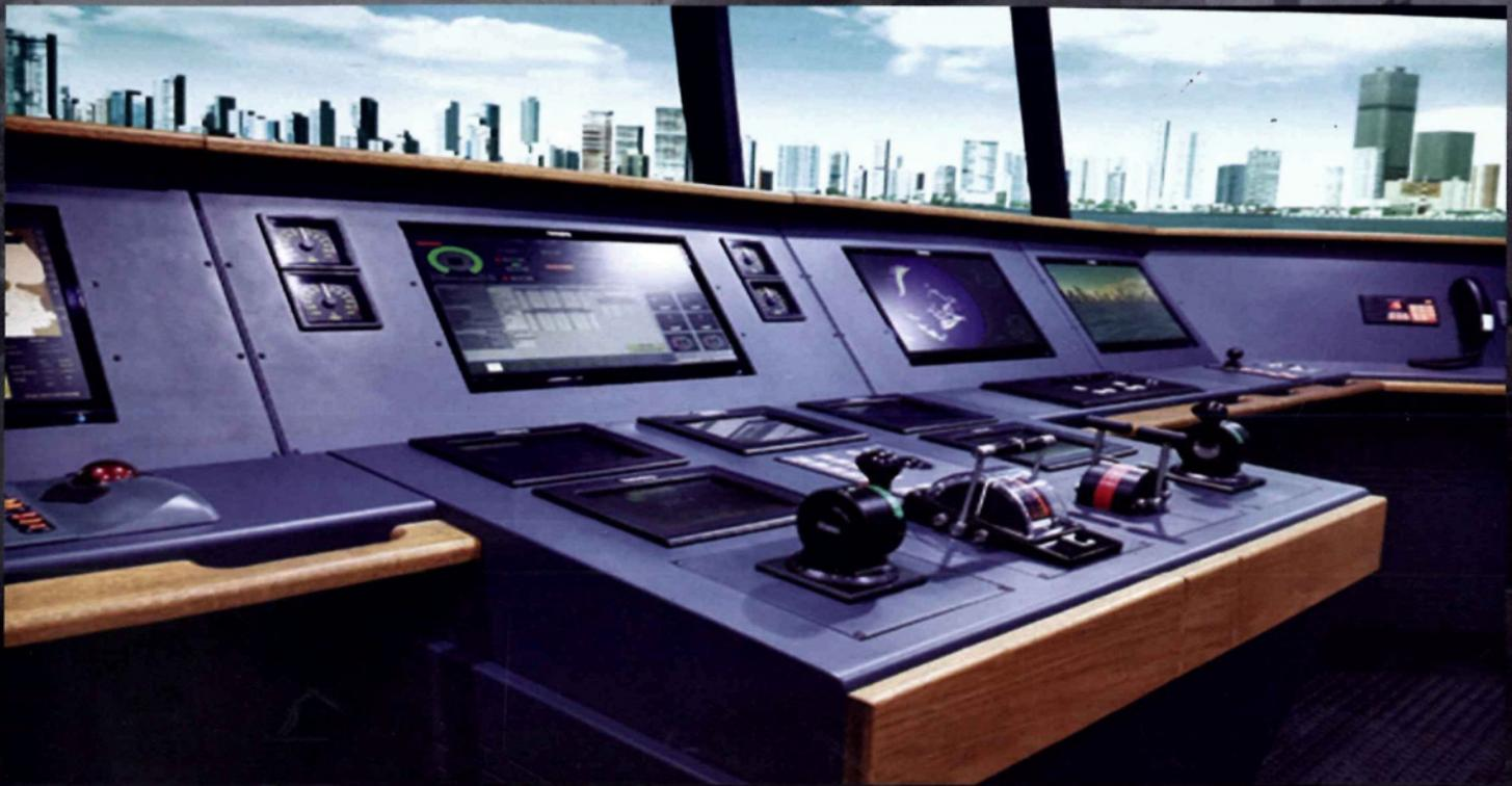
Dicha plataforma dispone de una configuración de controles reales de sistemas de propulsión azimutal, esto con el propósito de simular maniobras de buques que cuenten con este tipo de sistema a bordo.
