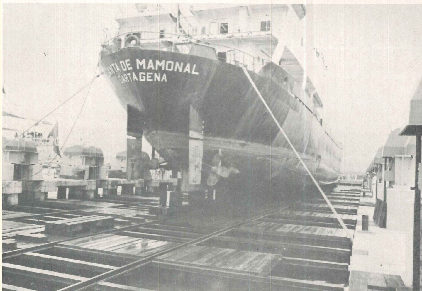
Vista de popa del sincroelevador se aprecia la cubierta en madera y los rieles sobre los cuales corren los carros.
